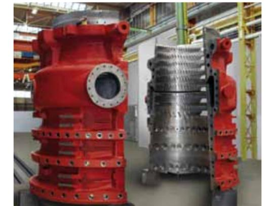
Gasturbinengehäuse zur Stromerzeugung, Gewicht 40 Tonnen.
